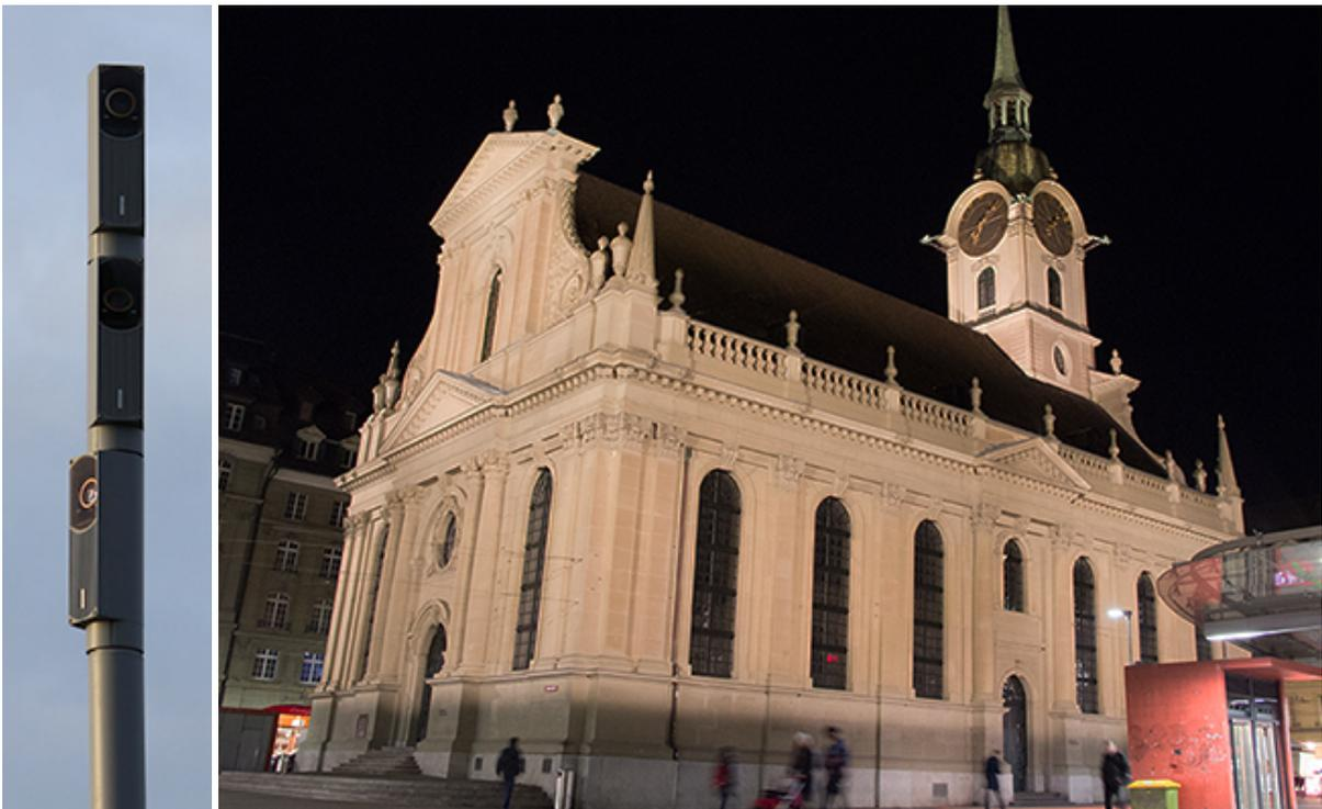
*Figure 23 : Treize projecteurs montés en sept points sur des toits voisins ou sur les poteaux de l'éclairage public (photo de gauche) éclairent l'église du Saint-Esprit devant la gare de Berne (photo de droite ; source : Energie Wasser Bern). Dans les projecteurs, des masques créés sur mesure guident précisément la lumière. Cela permet de produire des différences de clarté et de mettre en évidence des détails tels que la balustrade du toit décorée de vases et d'urnes sur le côté de l'église.*
